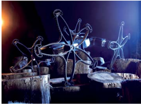
Der robuste, wasser- und staubdichte Roboter ASGUARD bewegt sich sicher in unebenem Gelände. Das am DFKI entwickelte System kann mit Sensoren ausgestattet werden, die Informationen vom Zielort liefern
